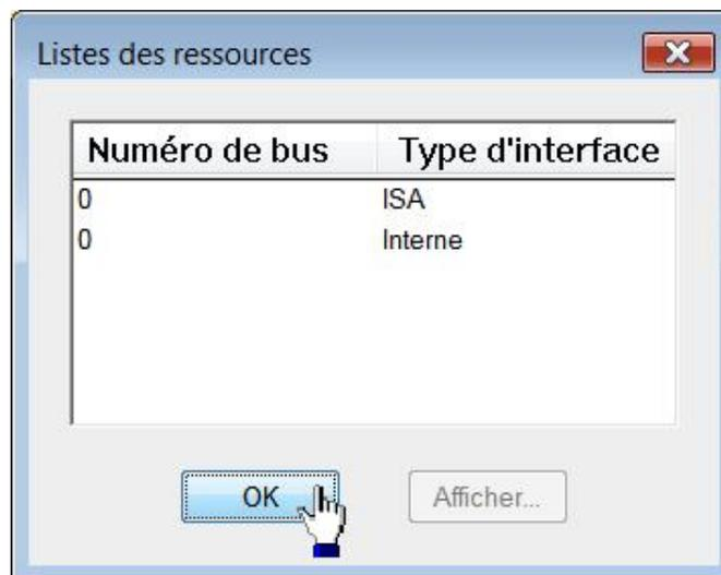
REG\_RESOURCE\_REQUIREMENTS\_LIST : ce type de valeur est constitué d'une série de tableaux imbriqués et destinés à stocker la liste des ressources matérielles utilisées par un pilote de périphérique et le composant qu'il contrôle.
